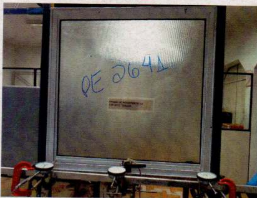
Foto nº. 01 Ensaio de resistência ao esforço torsor.
