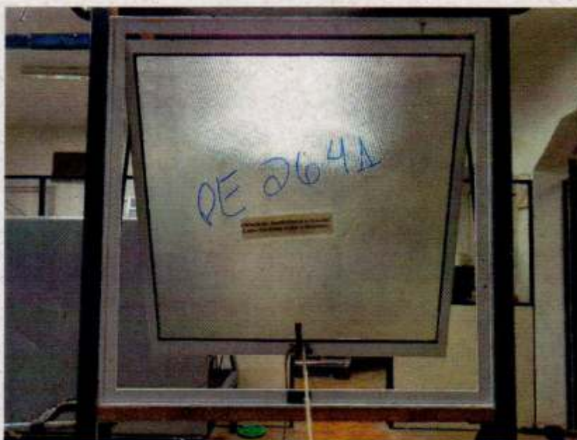
Foto nº. 03 Resistência à flexão: Do lado externo para interno
